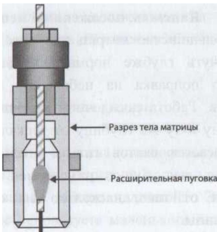
**Матрица для выставления зеркального зазора и расширения шейки.**
